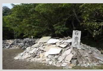
適正処理困難物 （石膏ボード）
