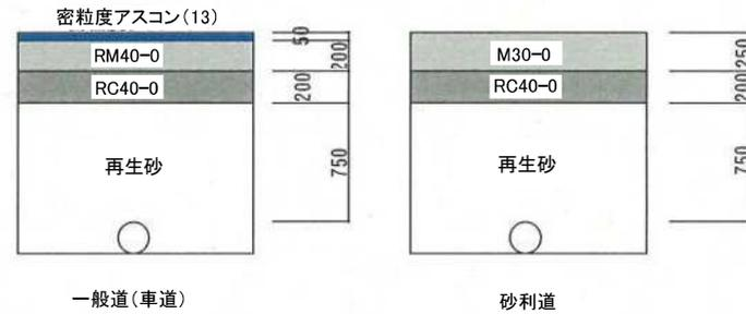
図1~5の他、復旧の施工端から舗装絶縁線までの距離が1.2m未満(歩道については0.8m未満)の場合は、当該部分を含めて施工すること。道路部分を工事する際、保安関係等を行い事故防止をすること。舗装(路盤含む)は、雨天施工はしないこと。
